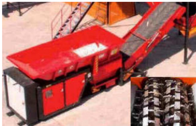
Figura 15: Processo de Trituração - <50mm do RSU
